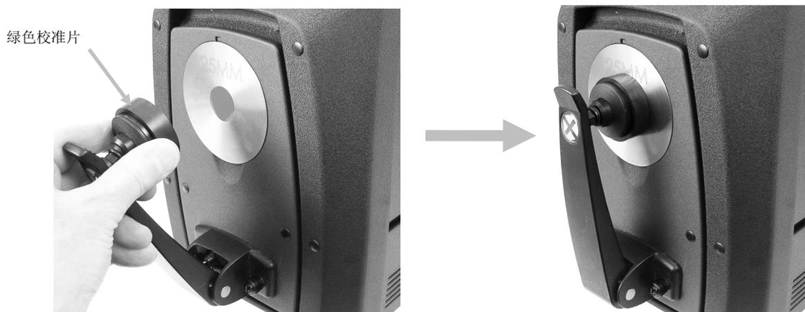
4. 在软件应用程序中启动绿色校准片检查步骤。测量完成后，取下绿色校准片并放回附件抽屉。
