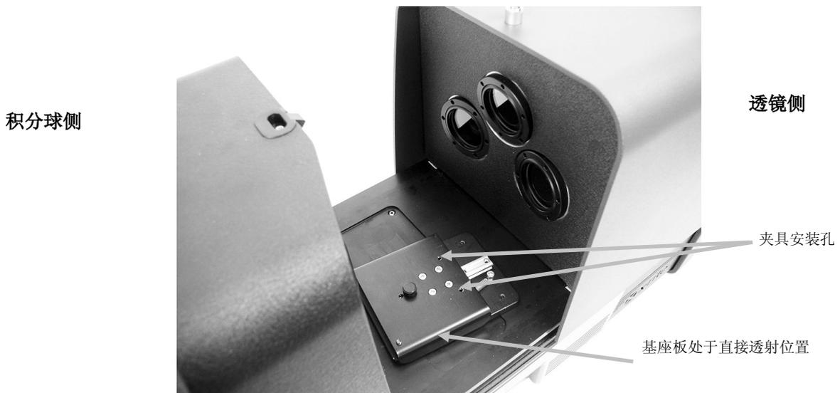
5. 使用指旋螺丝，将 25 毫米色样挡板安装在基座板，将 25 毫米夹具安装在支架基座上。
