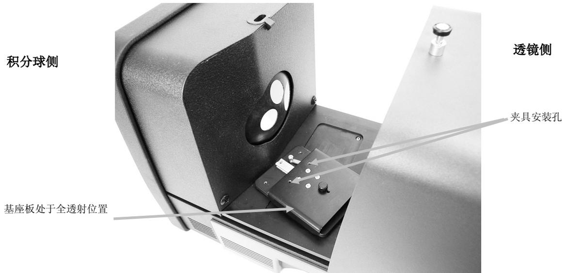
**5.** 使用指旋螺丝，将合适的色样挡板安装在基座板，将夹具安装在支架基座上。我们建议使用具有所有尺寸（包括 25 毫米）的挡板。
