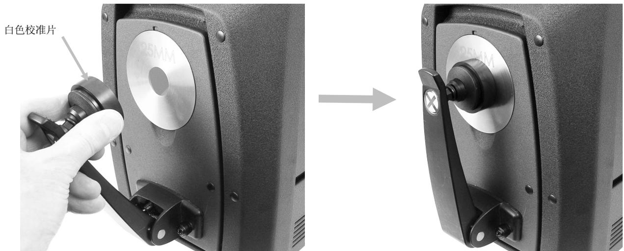
5. 从软件启动测量校准片。测量完成后，取下校准片并放回附件抽屉。
