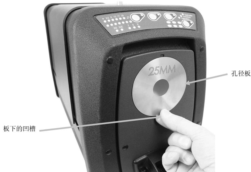
3. 在附件抽屉里找到要安装的孔径板，将孔径与色样门的边沿对上。磁铁会将孔径板固定在位。
