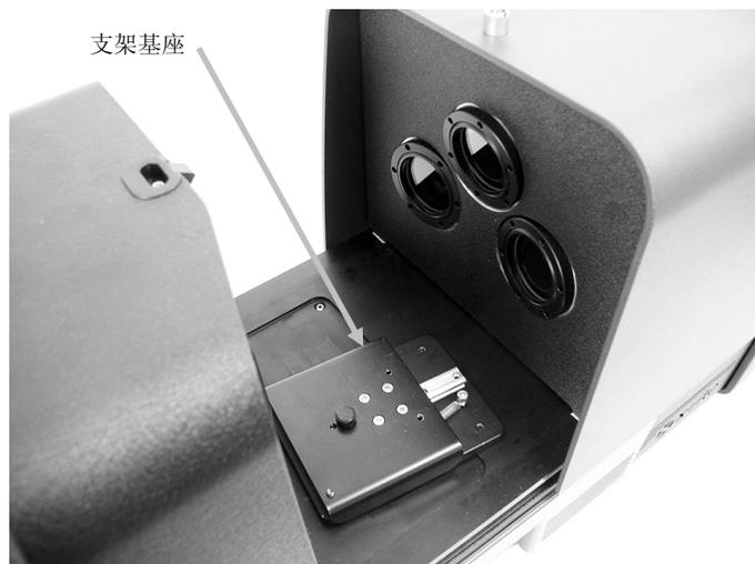
2. 使用指旋螺丝，将合适的夹具和挡板安装在支架基座上。
