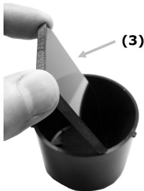
4. 用清洁干燥的空气 (4) 对着黑筒玻璃表面和黑筒里面急迫短促地吹。
