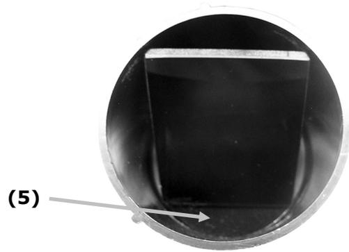
6. 将基座凹槽对准黑筒中的凸舌，向右旋转直至紧扣到位。注意：基座凸舌是有方向性的，只允许安装在一个位置。确保您没有用力迫使它装在黑筒上。
