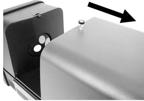
6. 在进行透射测量时，色样固定在位是使用在色样积分球一侧带挡板的透射支架，以及远离积分球在色样一侧的弹簧夹具板。
