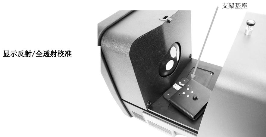
2. 使用指旋螺丝，将合适的夹具和挡板安装在支架基座上。
