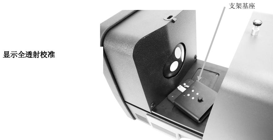
2. 使用指旋螺丝，将合适的夹具和挡板安装在基座上。
