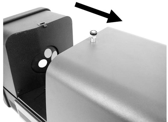
**4.** 将透射区内色样架基座板上的销对准基座板安装通道孔。
